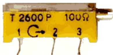
La resistenza RV che si trova nel circuito di base del transistor, è una resistenza variabile, detta anche trimmer. Nella pratica può avere l'aspetto di uno dei tipi che si vedono nella figura a sinistra; si tratta comunque di una resistenza il cui valore può essere regolato tra zero e il massimo (che è il valore indicato sulla
