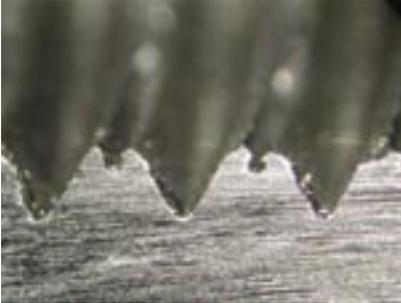
Sezione di un filetto ottenuto con maschio a rullare su acciaio C45
