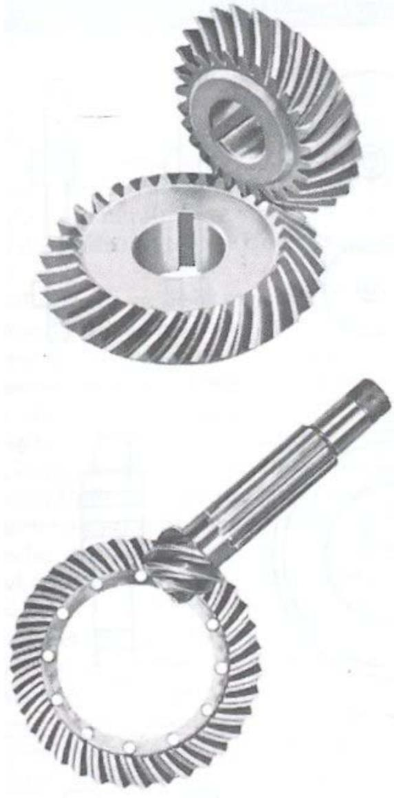
Coppie di ruote coniche: a) con denti a spirale, b) ipoidi, con assi di rotazione giacenti in piani ortogonali ma non concorrenti.
